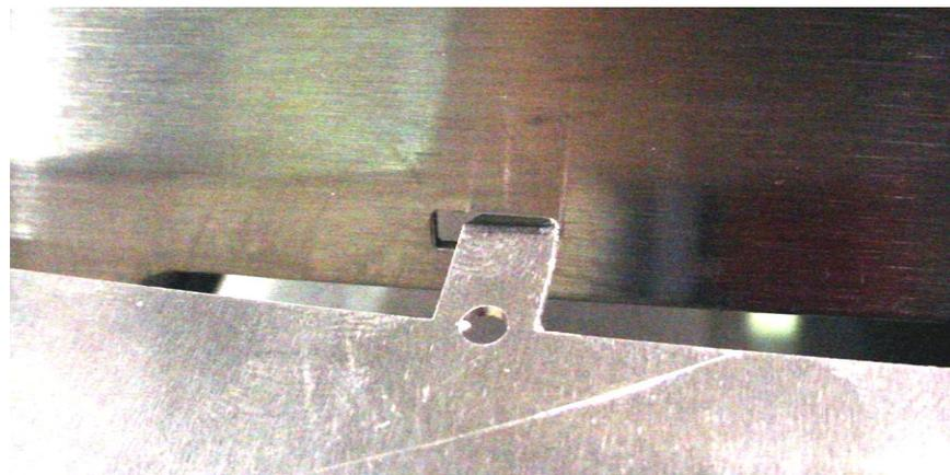
Usando pinzas, doble las orejas para asegurar los deflectores al calentador.
