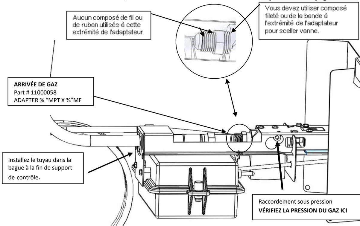
**Attacher extrémité i votante certifiée at approuvée assemblage di tuyaude gaz a haule (fourni avec l'appareil) pression noir à clapet. Serrer à l'aide de ¾" et 11/16" clés.**
