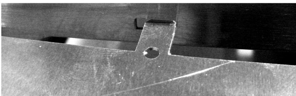
**En utilisant des pinces multiprises, pliez les languettes pour attacher les déflecteurs au chauffage.**
