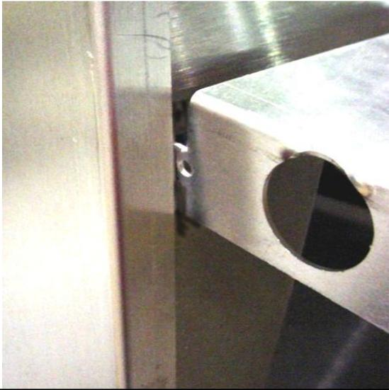
**REMARQUE :** La face étroite et percée des déflecteurs est orientée vers la face extérieure du chauffage.
