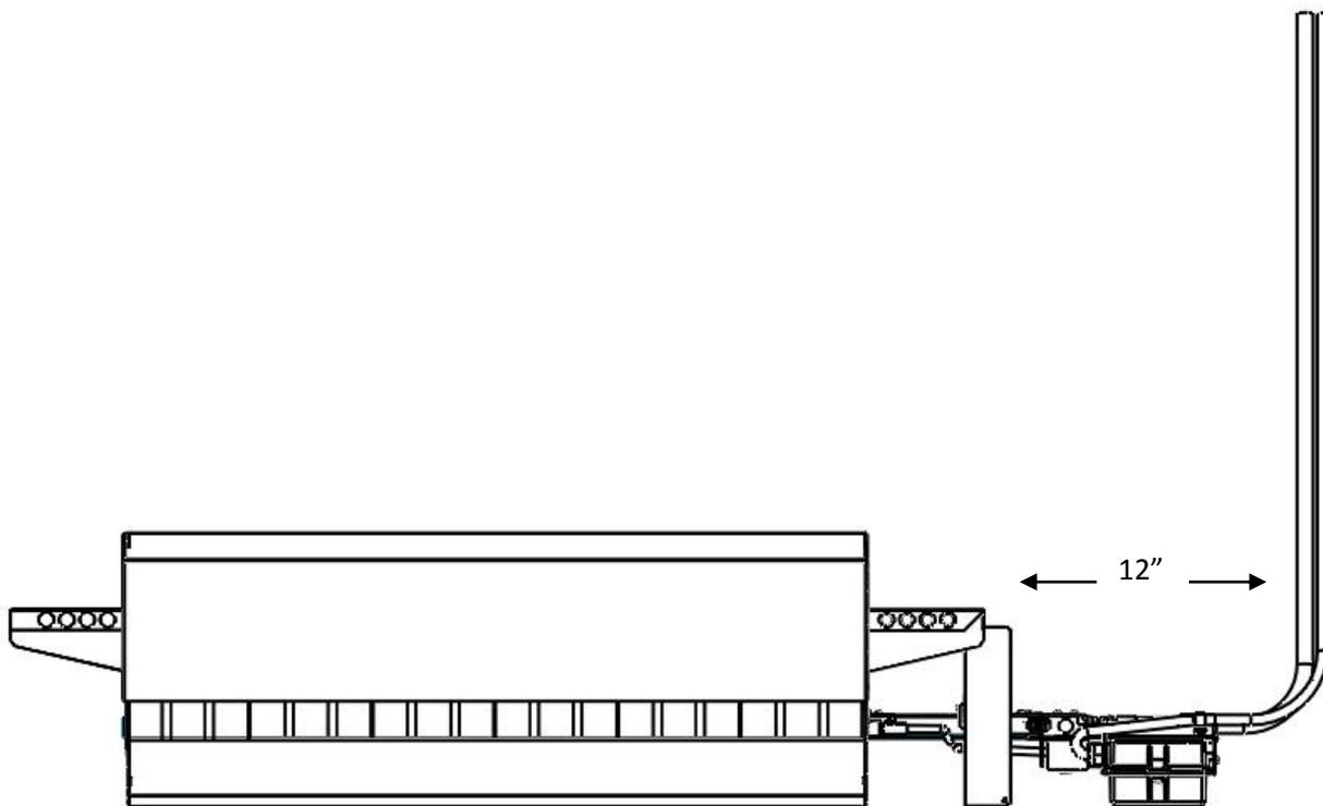
L'installation de l'alimentation de gaz indiquée dans l'illustration ci-dessus permet au tuyau d'alimentation de gaz d'être suspendu LOIN des surfaces du chauffage, même pendant l'élévation de l'unité en treuil.
