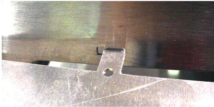
**En utilisant des pinces multiprises, pliez les languettes pour attacher les déflecteurs au chauffage.
